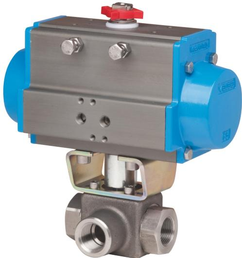
3-Wege-Kugelhahn Edelstahl AISI 316L, "T" oder "L" Bohrung, Ablenker, Gewindeanschluß I/I/I, für Hochdruck, mit Antrieb, für hydrauliköl, Emulsion, Erdgas. Für besondere Anwendungen, bitte kontaktieren Sie unser Vertriebsbüro.
