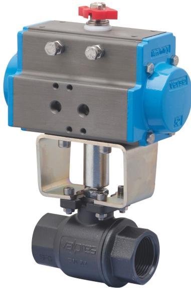
2-Wege-Kugelhahn [Valpres Art. 705000] aus Stahl ASTM A105-WCB, Kugel und Spindel aus Edelstahl AISI 304, Gewinde I/I, voller Durchgang, mit Antrieb.
